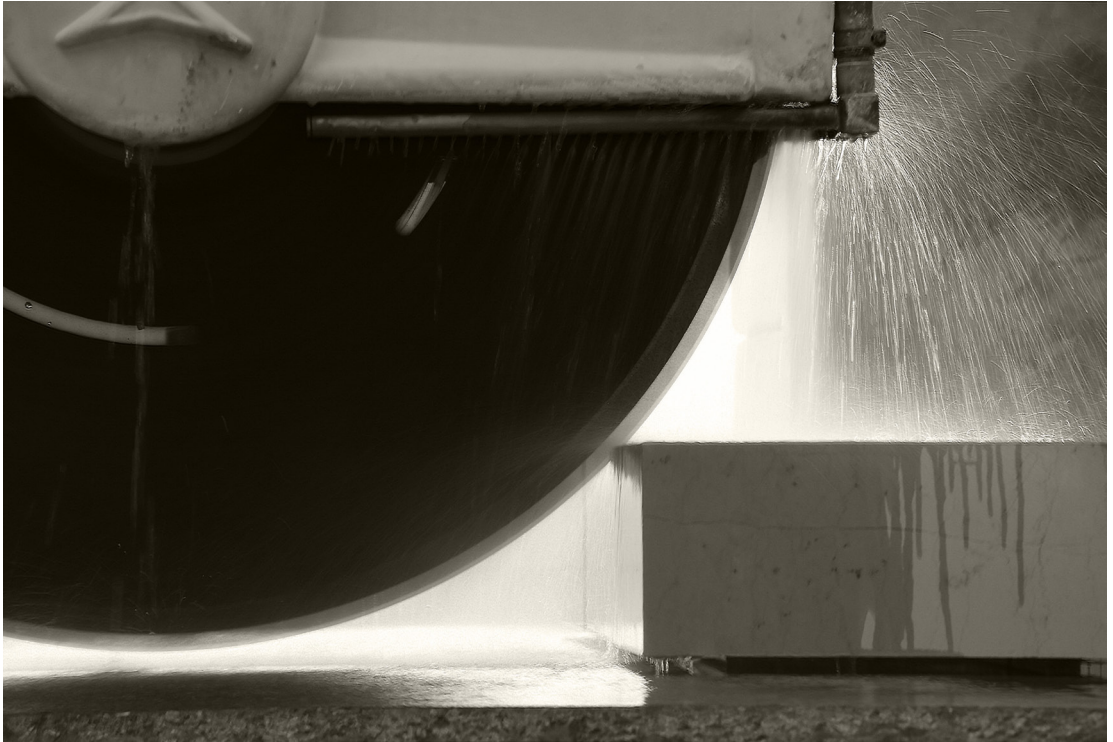
Découpe mécanique d'un bloc de pierre, Atelier Grain d'Orge, Grane
