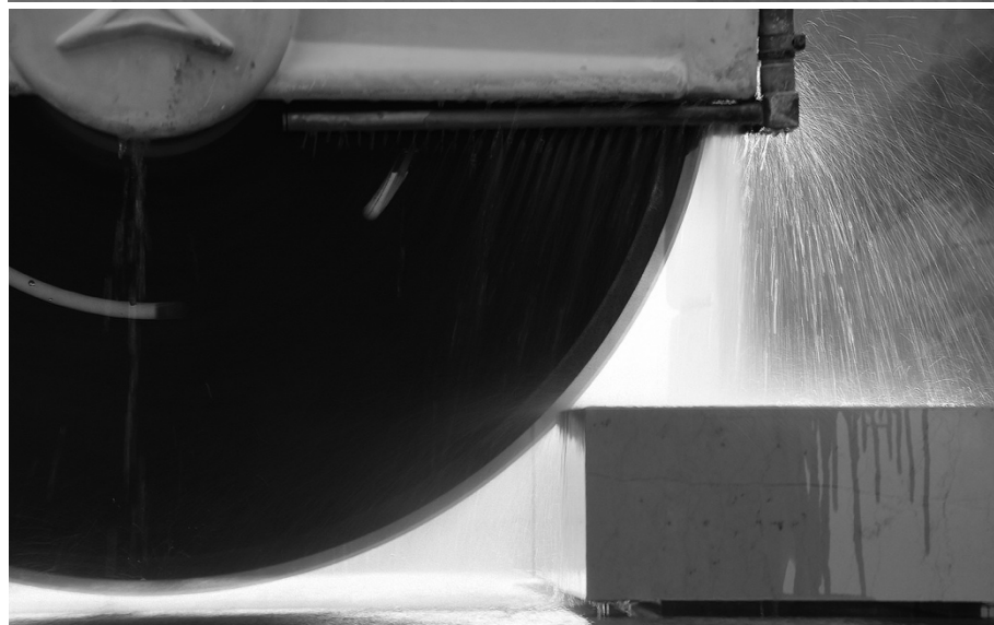
Illustration 10 Mur en Pierre du Chais des Frères Delas Par Carl Fredrick Svensdtet. La seconde image représente la taille d'une pierre à la scie numérique. C'est le même procédé qui a été utilisé pour construire le mur.
