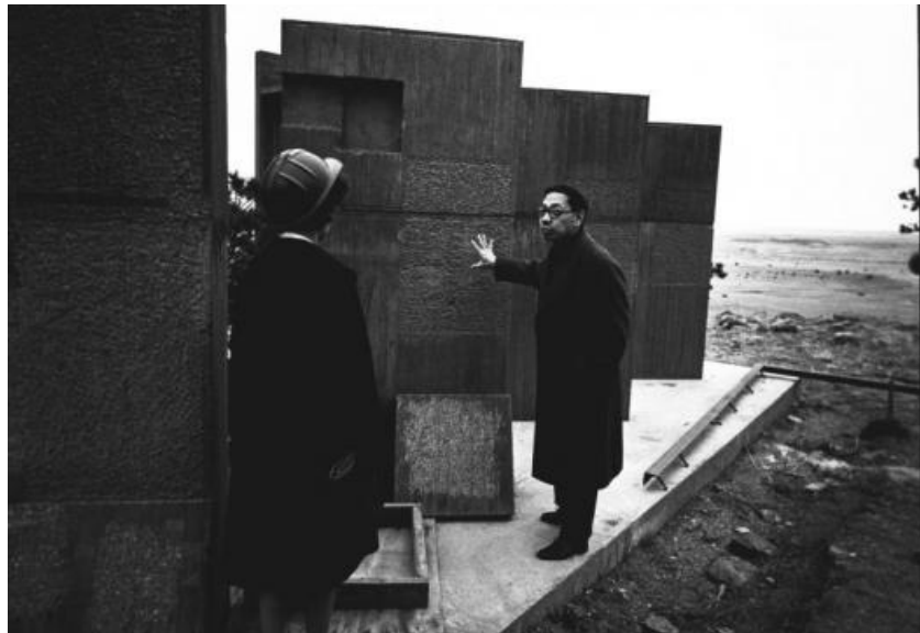
Illustration 19 En Haut, Le laboratoire de l'UCAR dans le Mesa Verde. En bas I. M. Pei qui fait des tests de panneaux béton avant de choisir la bonne finition qu'il mettra en œuvre
