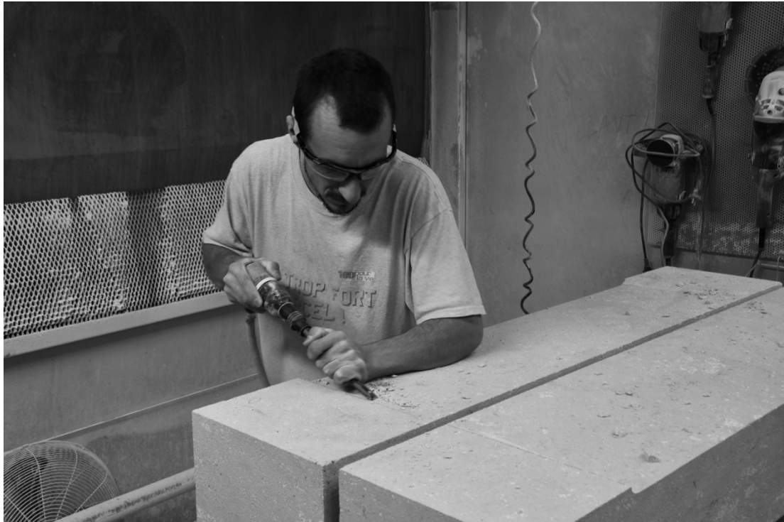
Illustration 4 Artisan de l'atelier du Grain D'orge en train de retravailler à la main avec son outil une pierre.
