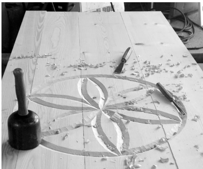
Illustration 15 En Haut, La matérialité du béton utilisée dans l'atelier Bardill construit par Valerio Olgiati et en bas le coffrage taillé à la main utilisé pour produire les moulages dans le béton.
